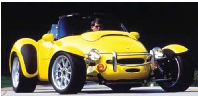
gia (SUA), compania Panoz Auto Development. Deja în 1990 este propusă premieră – prototipul roadsterului Panoz, a cărui producție a început în 1992. Caroseria era din aluminiu, fiind modelată prin tehnologii aerospațiale. Motorizarea a fost împrumutată de la Ford Mustang – un V8 de 5 l, tot de la Mustang erau suspensia și transmisia.
